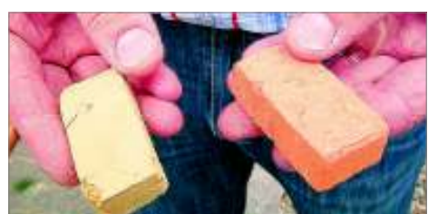
Ein erlebbarer Wandlungsvorgang: gebrannter (r.) und getrockneter Lehm.
